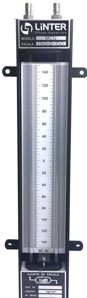
Construído com tubo de vidro em forma de “U” com orifício interno rigorosamente calibrado, com espessura de parede de 2mm, base de alumínio com abas de proteção de vidro e suporte para fixação, os manômetros de coluna **Linter Filtrros** são destinados à medição de vácuo ou pressão positiva e pressão diferencial para aferição e calibração de instrumentos de pressão baixa.
