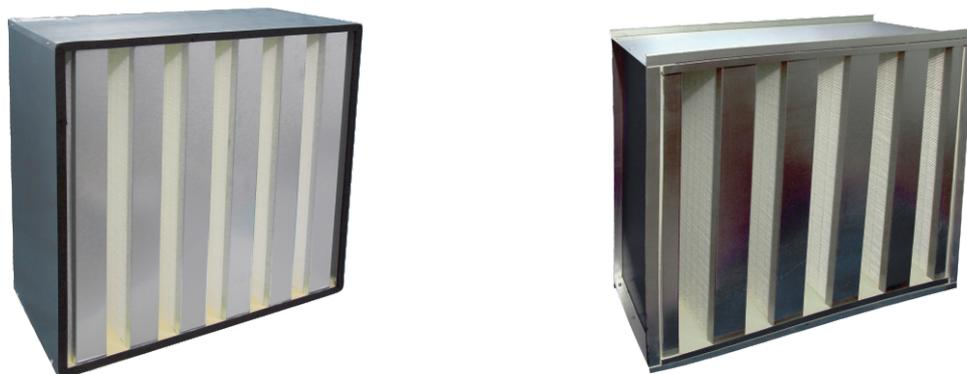
Os **Filtros Absolutos HEPA**, modelo N, são fabricados por processos que incluem tratamento extremamente cuidadoso do material. O elemento filtrante é produzido a partir de microfibras de vidro plissado de alta qualidade, permitindo velocidade de fluxo no meio filtrante 100 vezes maior do que o elemento filtrante plano. Sua área de filtração aumenta a captura de partículas e cordões especiais são inseridos entre plissas para manter um espaçamento uniforme.
