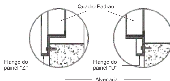
DETALHE DE FIXAÇÃO
